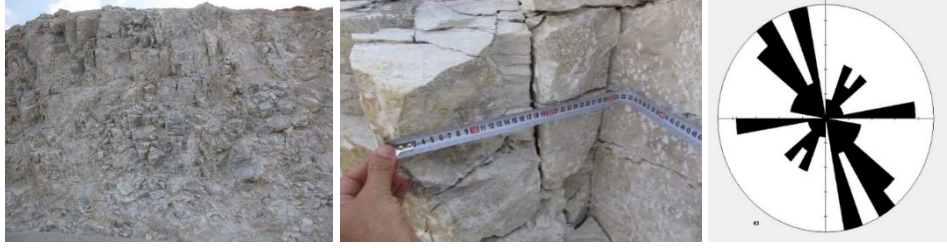
Şekil 1. Örnek bir hat etüdü çalışmasında kaya yüzleklerinin görünümü (solda), çatlak aralıklarının ölçümü (ortada) ve alınmış süreksizlik ölçümleri ile hazırlanmış gül diyagramı (sağda).
